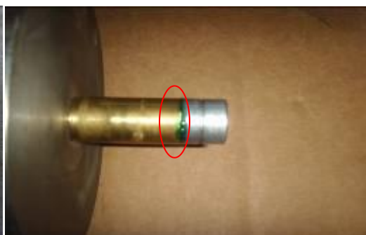
图 10 胶水溢出示意图
