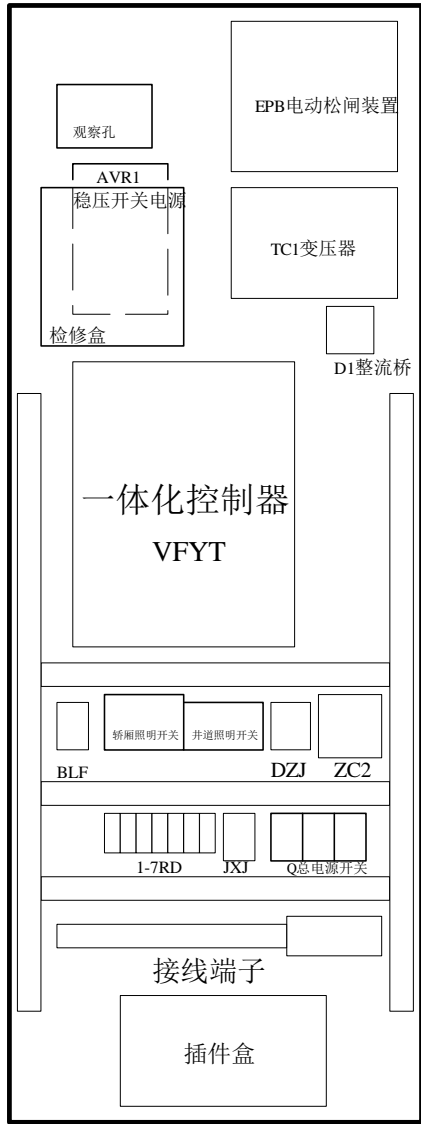
无机房控制柜
