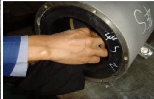
图 6 清理制动器内部
