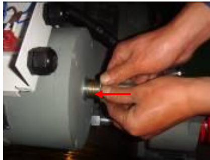
图 3 柱塞的灵活度检查
