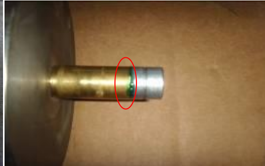
图 10 胶水溢出示意图
